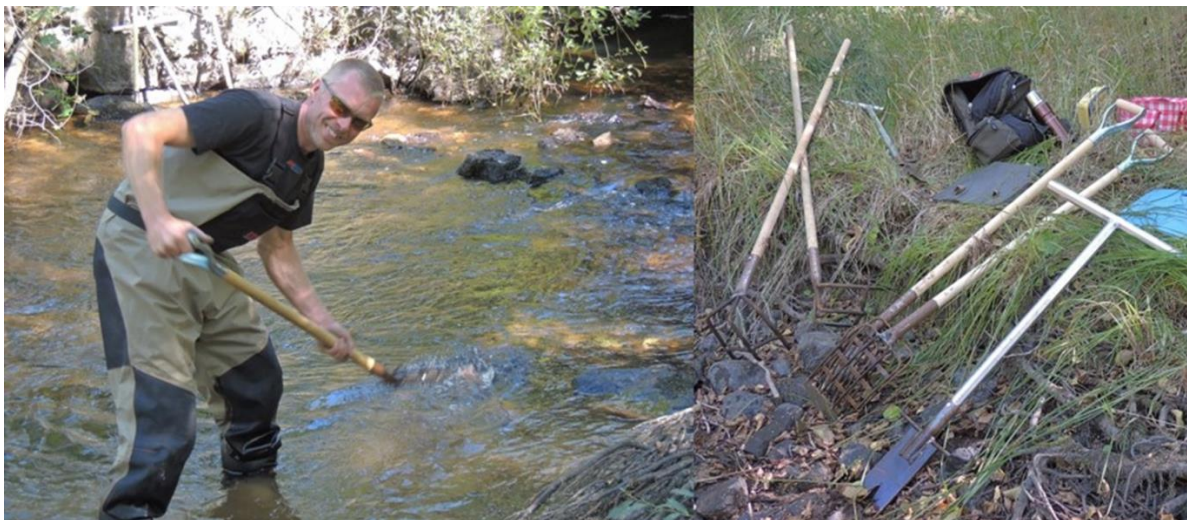
4 Till vänster: Anders använder sällningsverktyget. Till höger: Från vänster, två stenrullningsverktyg, två sällningsverktyg och ett bändningsverktyg.
